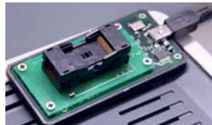
► Программатор для считывания дампа из микросхем памяти NAND flash.
